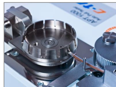
Spannglocke mit 14 Schlitzen
