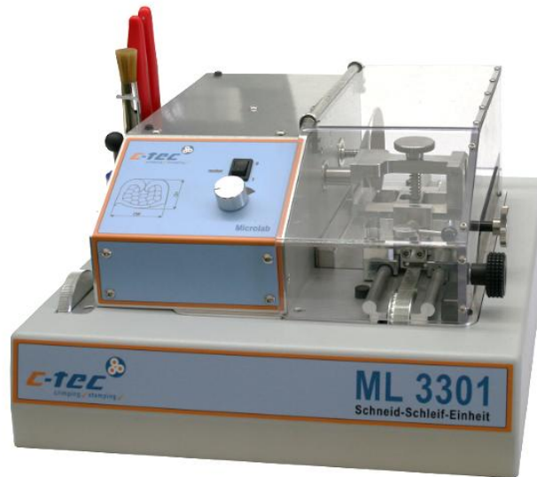
Schneid- und Schleifeinheit ML 3301 integriert in ein Aluminium-Gehäuse
