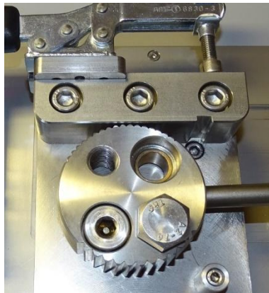
Kabelspannsystem umgebaut auf Feinverzahnung.
